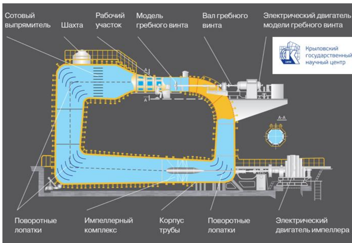
Рис.4.7 - Схема кавитационного опытового бассейна
