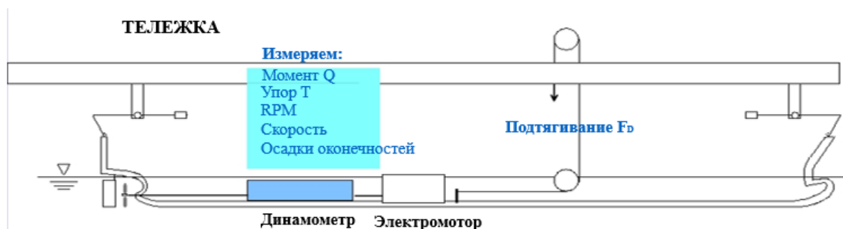
Рис.4.4 - Схема измерительной аппаратуры при испытаниях
